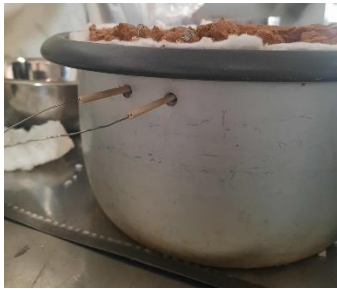
Ilustración 2. Vista lateral del horno de la colocación de termopar.
