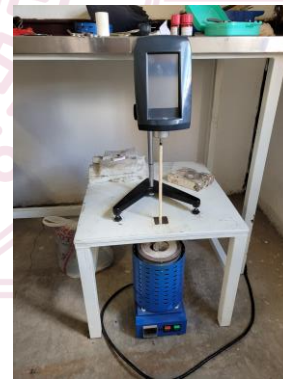
Fig. 1. Montaje del equipo para la medición de las viscosidades a diferentes temperaturas.
