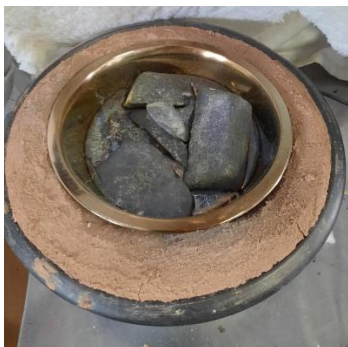
Ilustración 4. Vista superior del horno mientras se realiza la primera fundición de la aleación Pb-Ag.
